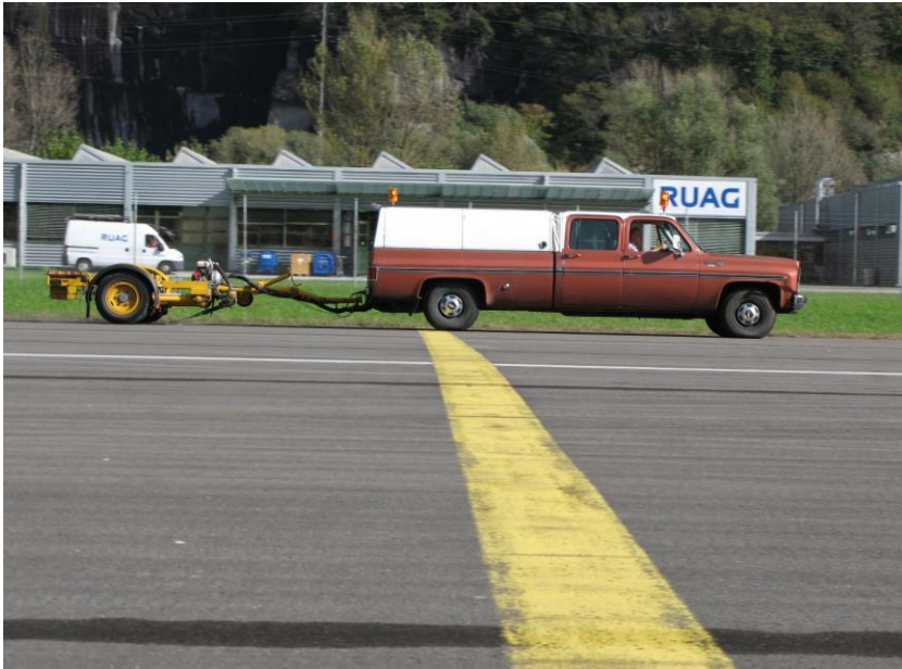
Foto 5.4: Messung der Griffigkeit mittels Skiddometer auf dem Flugplatz Lodrino
