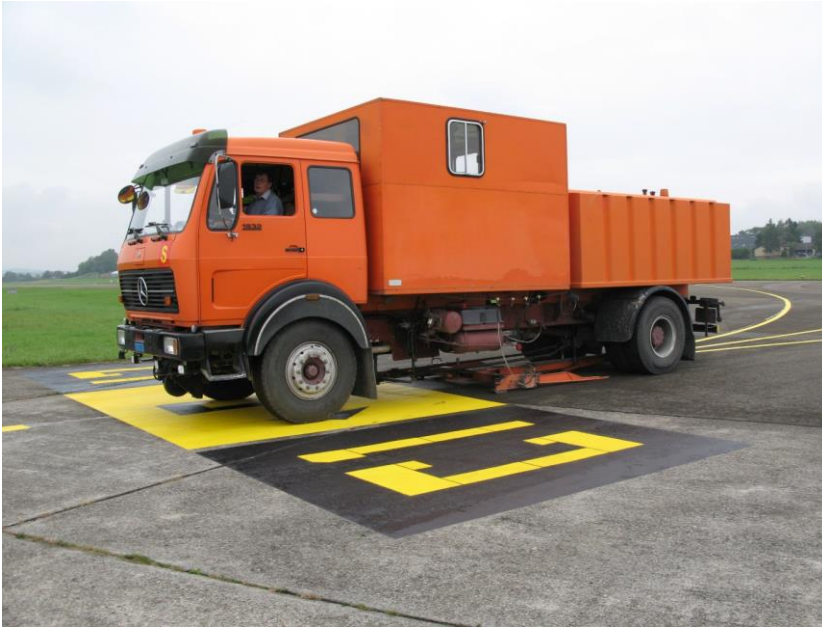
Foto 5.2: Einsatz des Lacroix-Deflektographen der SACR AG auf dem Flugplatz Dübendorf
