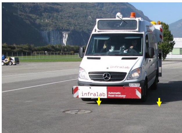
Foto 5.5: Laserabtastung der Oberfläche alle 12.5 mm
