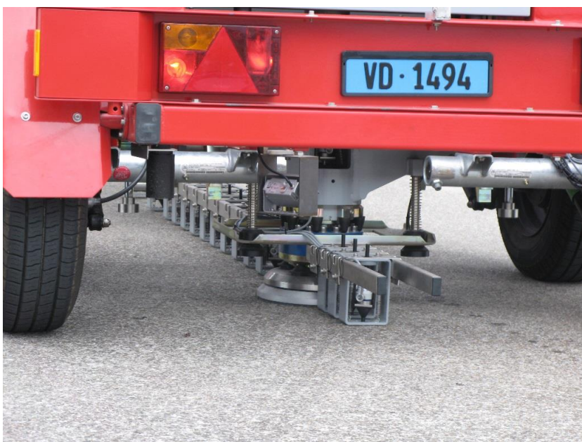
Foto 5.3: Messung der Tragfähigkeit mit dem Heavy Weight Deflectometer
