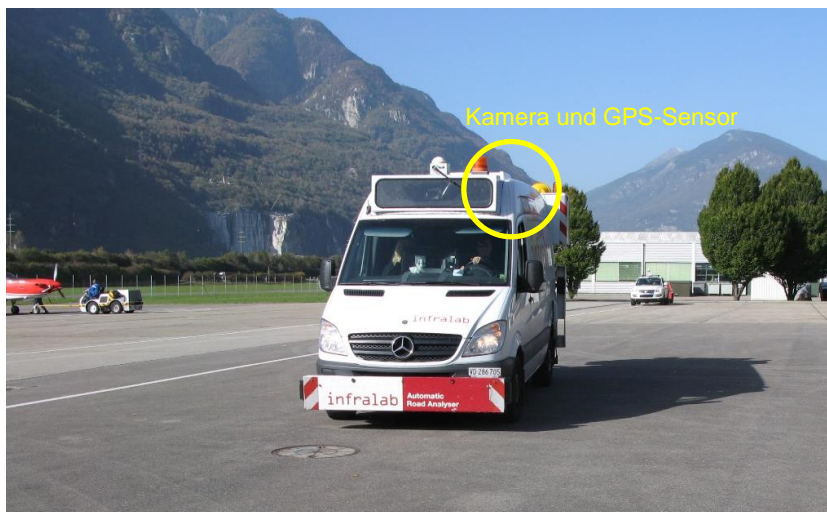
Foto 5.1: Aufnahmen mit dem ARAN-Messfahrzeug auf dem Flugplatz Lodrino
